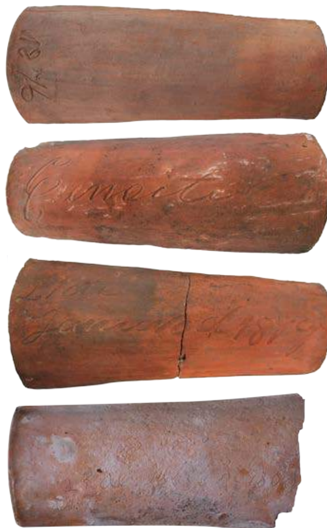
Telhas do século XIX, datadas e assinadas. Retiradas de residências que foram demolidas, em Lages, hoje integram o acervo do Museu Thiago de Castro. A telha de baixo, preservada na fazenda São João, em Lages, apresenta o ano 1800 (ou 1860), indicando provavelmente a data de inauguração da construção ou alguma reforma sofrida em seu telhado. Fotos: Charles Steuck, 2014.
